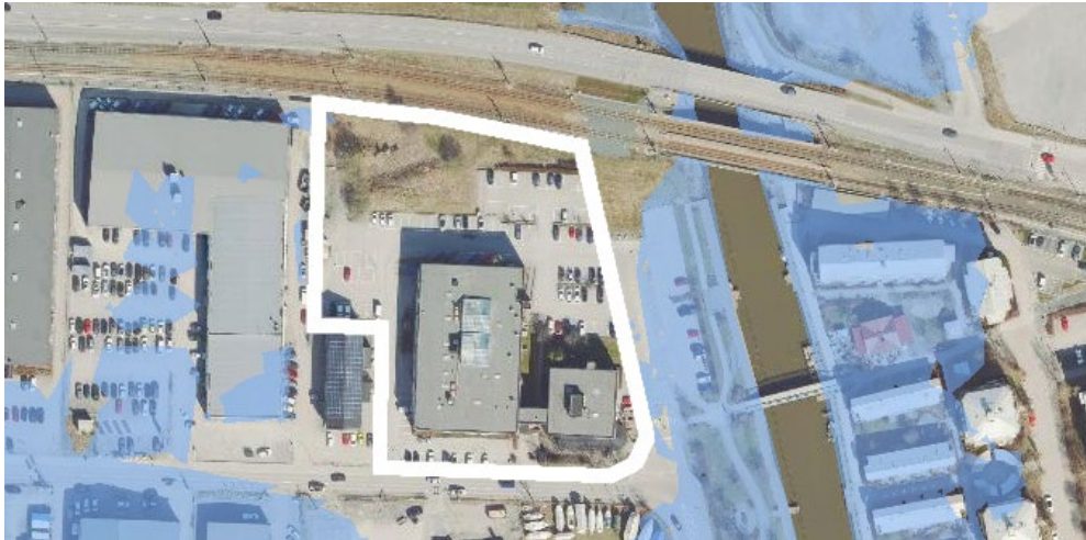
Figur 6. Lägsta rekommenderade grundläggningsnivå (2,7 meter över nollnivån i RH2000) i blått.
